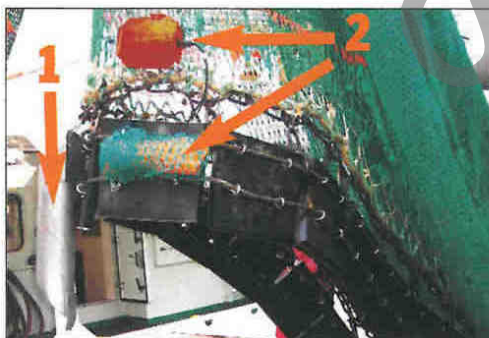
Pruebas con el Sensor de Contacto con el Fondo (1) instalado en una nueva placa de aparejo en el buque de investigación G.O. Sars. Observe que el Sensor de Ángulo (2) se han instalado en la placa del aparejo para controlar la inclinación del ángulo mientras se arrastra.
