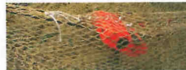
EL SENSOR DE VELOCIDAD: instalado en el extremo frontal del paño de 80 mm en el buque "Eros".
